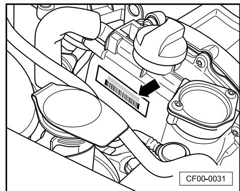
此外，发动机型号代码还在汽车铭牌上和变速箱上方的曲轴箱上列出-箭头-。
